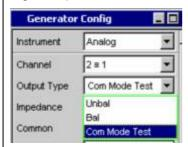
Remote control command: OUTPut:TYPE CTESt
